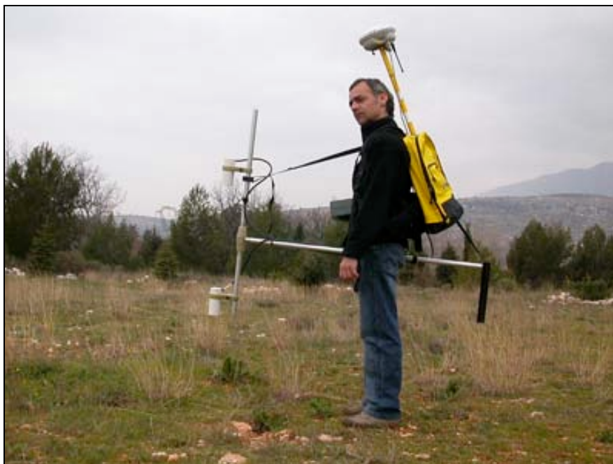
Photo 4 : Méthode cartographie magnétique (sur la photo : Pierre Etienne Mathé)
