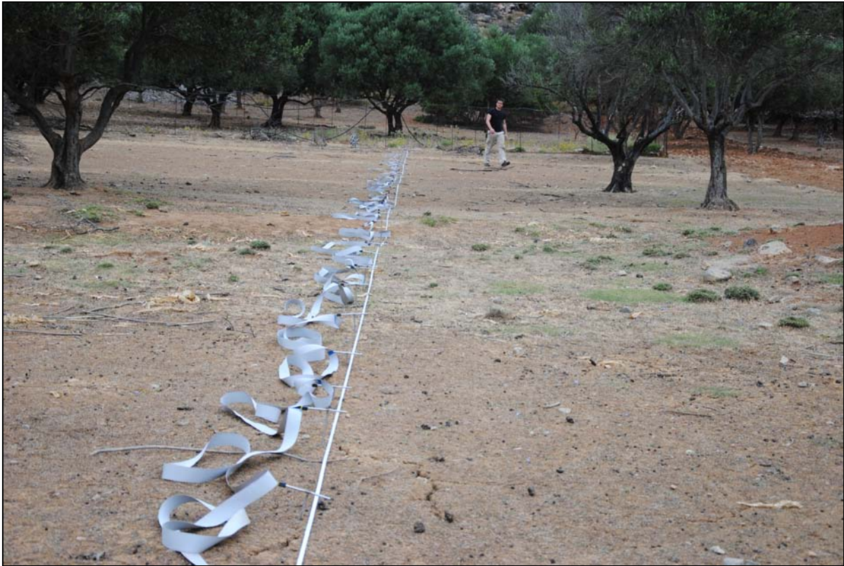
Photo 2 : Câbles reliés aux électrodes
