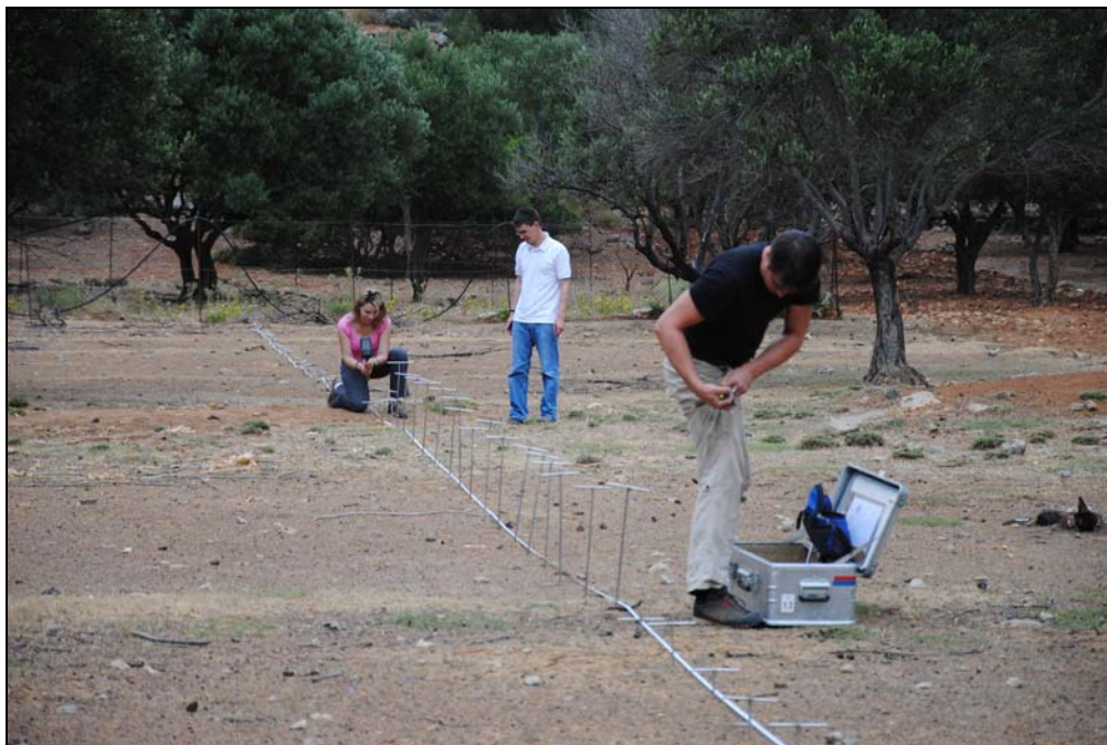
Photo 1 : Implantation des électrodes pour mesure d'ERT
