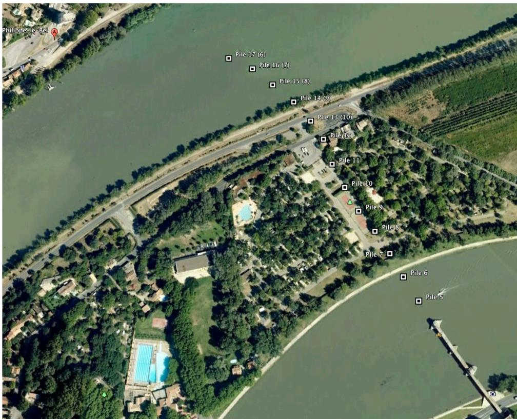
Positionnement théorique des piles avec un entre-axe moyen de 40m.
