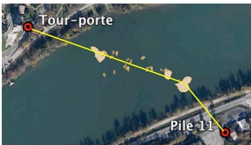
Figure 2 – Les données de la caméra acoustique dans le bras de Villeneuve, comparées à l'axe présumé de la dernière section du pont
