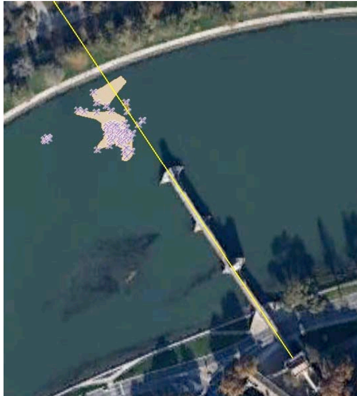
Figure 1 – Les données de la caméra acoustique pour la zone de la pile 5 comparées à l'axe de la première section du pont
